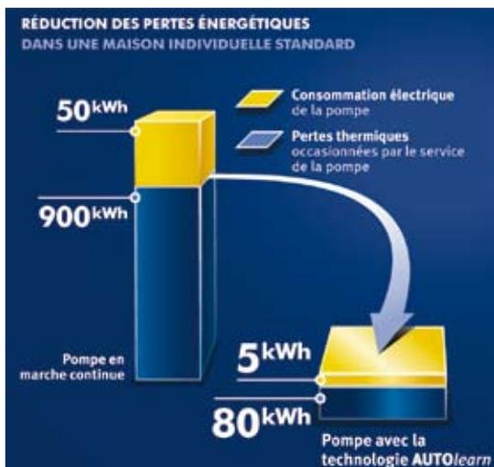
Figure 6 Réduction de la consommation électrique BWO 155 SL et des pertes thermiques
