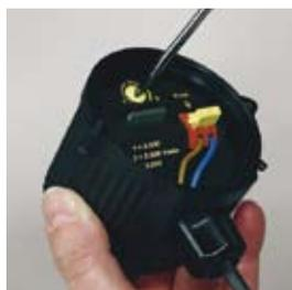
Le réglage standard correspond au «régime moyen» de 2500 tours/min, ce qui est convient parfaitement dans la plupart des cas. La puissance absorbée moyenne mentionnée ci-dessus n'est alors que de 5 Watt.
